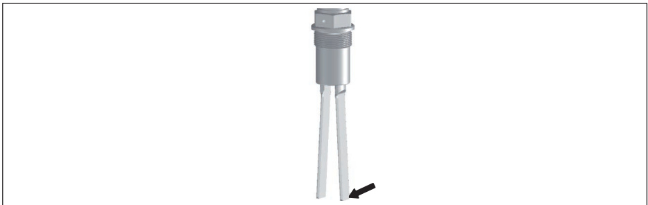
插图. 13: 朝向音叉侧的纵向的最大侧面载荷 (音叉的窄侧)
