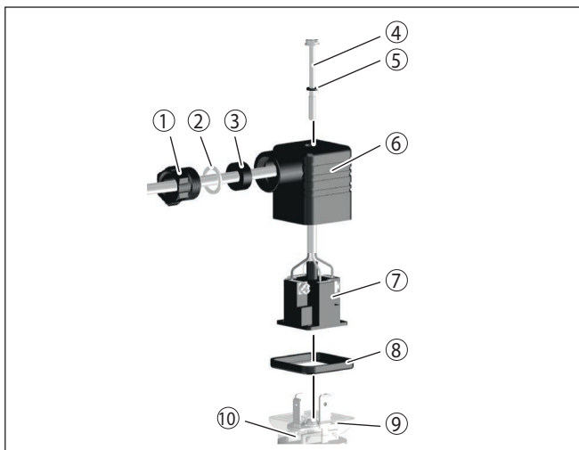
插图. 9: 阀门插头 ISO 4400 的连接方式
