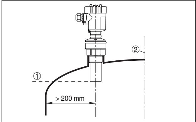
插图. 6: 安装在圆形容器盖上
