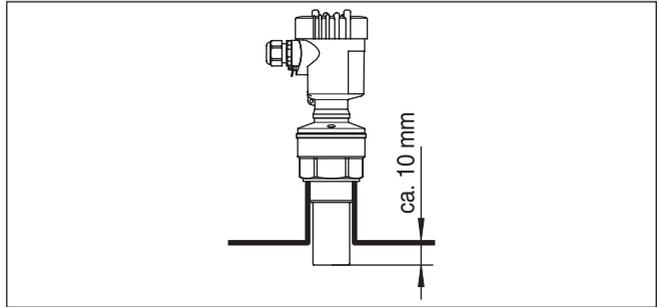
插图 8: 值得推荐的管接头安装方法
