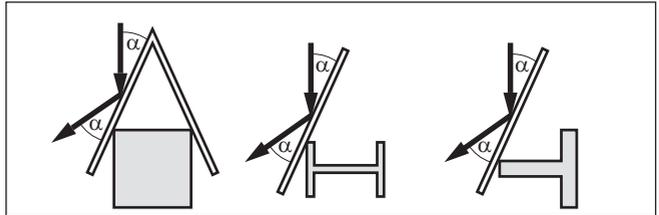
插图. 12: 用散射挡板来覆盖光滑的型材
