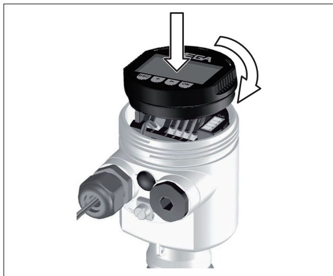
插图. 21: 将显示和操作模块装入单腔式壳体中
