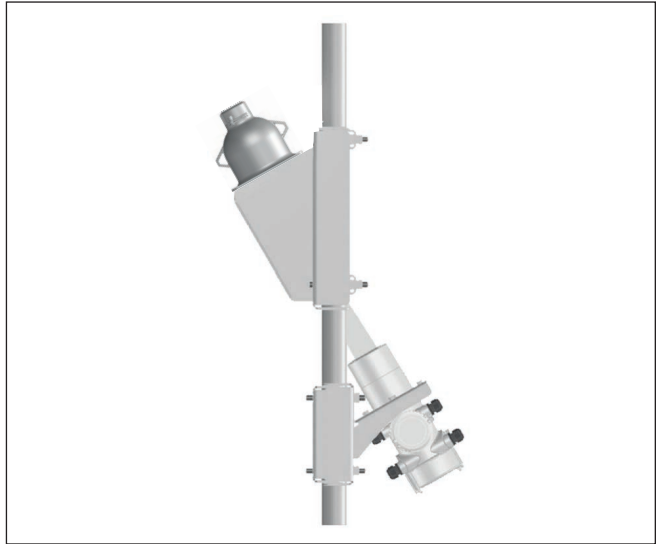
插图. 15: 将测量仪表倾斜 30° 安装在一个直径为 50 ... 100 mm (1.97 ... 3.94 in) 的管道上
