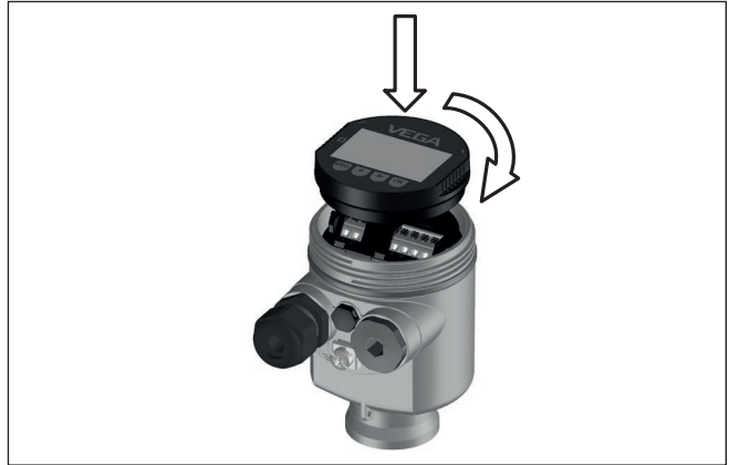
插图. 21: 将显示和调整模块装入单腔式壳体的电子部件腔中
