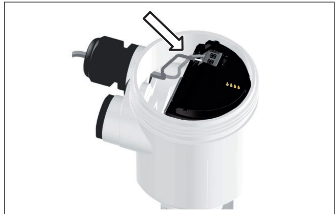
插图. 16: 连接步骤 5 和 6 - 单腔式壳体
