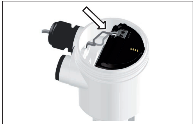
插图. 19: 连接步骤 5 和 6 - 单腔式壳体
