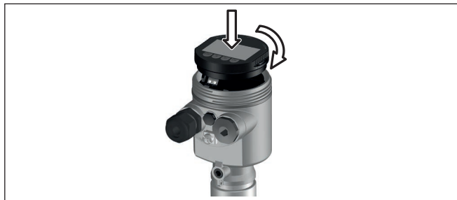
插图. 23: 将显示和调整模块装入单腔式壳体的电子部件腔中
